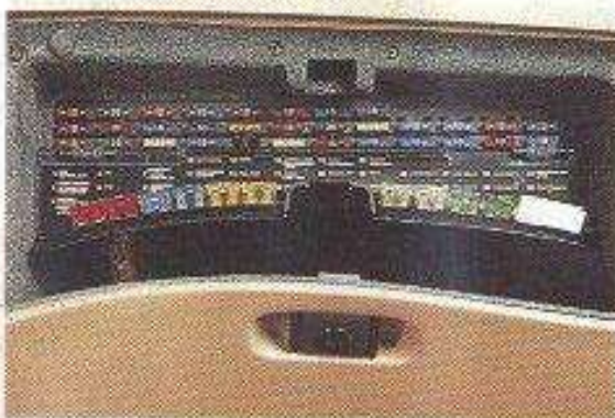
Blok elektryczny w schowku na tablicy rozdzielczej
