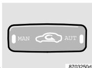
Recyrkulacja powietrza jest wtedy regulowana automatycznie. W celu przerwania zasysania do kabiny zanieczyszczonego powietrza, spalin itp. można ręcznie włączyć recyrkulację. Gdy włączona jest funkcja
