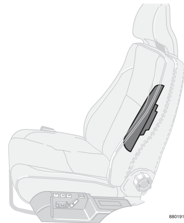
Boczne poduszki powietrzne umieszczone są w oparciach przednich foteli
