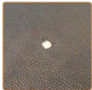
produkt jest następnie suszony przy pomocy opalarki w temperaturze 200 ° C.
