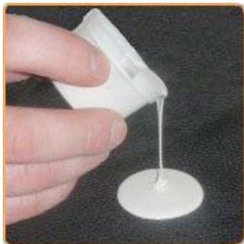
po trzech minutach wylej roztwór na kopiowaną strukturę.
