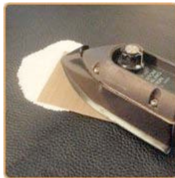
następnie przyłóż Grain Pad na wypełnioną dziurę, na wierzch nałóż papier termiczny i za pomocą żelazka odcisnij strukturę z Grain Pad-a przez ok. 1 minutę.
